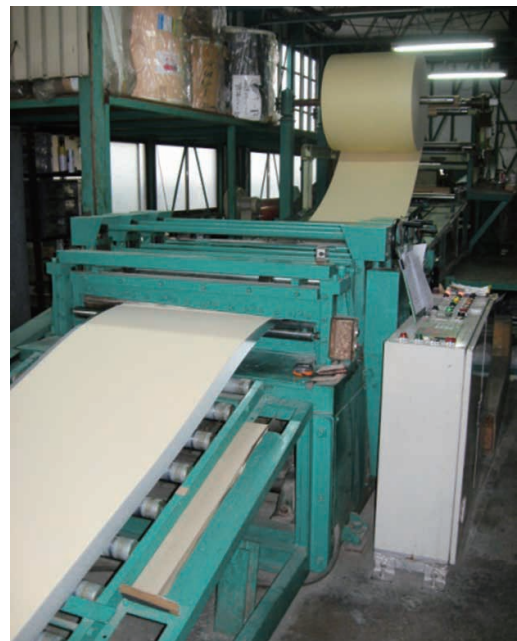
鋼板に断熱材を貼り付ける
